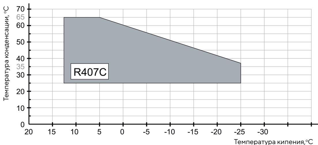
Рабочий диапазон этого компрессора, приведен при работе на R407C, условия работы: перегрев 11.1 К, переохлаждение 8.3К.
