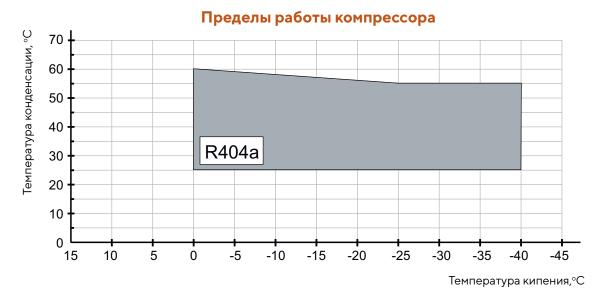
Рабочий диапазон этого компрессора, приведен при работе на R4O4a, условия работы: перегрев ОК, переохлаждение ОК.
